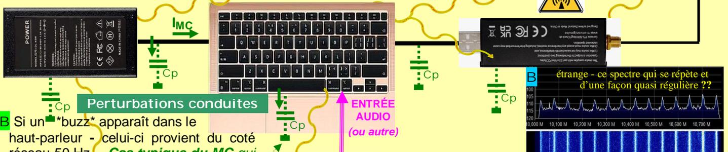
**B** Si un **"buzz"** apparaît dans le haut-parleur - celui-ci provient du côté réseau 50 Hz. **Cas typique du MC qui se reboucle à travers le plan de masse.**
