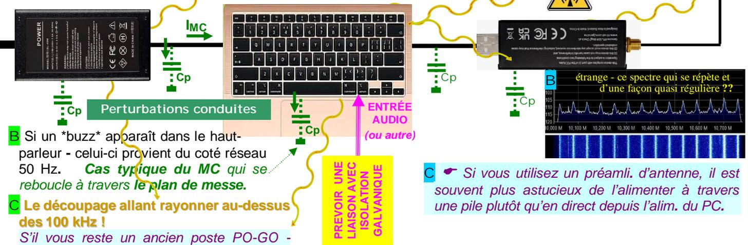
**B** Si un "buzz" apparaît dans le haut-parleur - celui-ci provient du côté réseau 50 Hz. **Cas typique du MC** qui se reboucle à travers le plan de masse.
